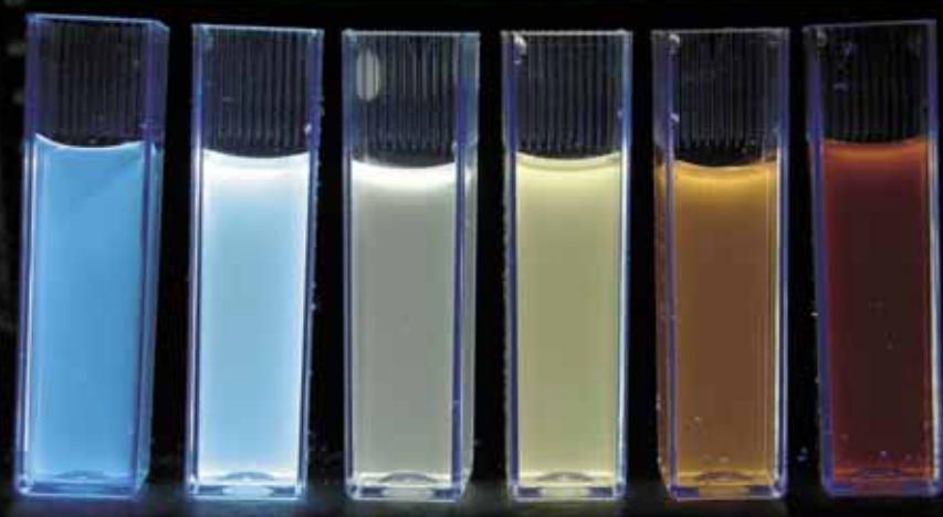
Флуоресценция полупроводниковых частиц сульфида кадмия (CdS)
