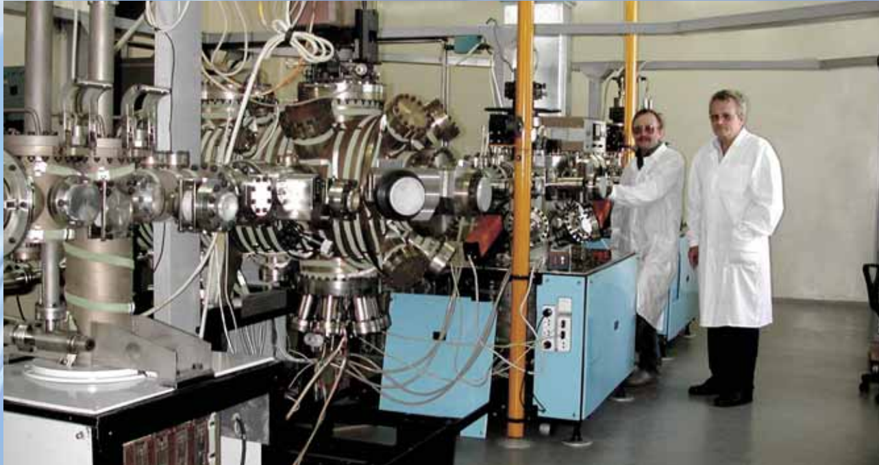
Установка молекулярно-лучевой эпитаксии «Обь-М», на которой выращивают полупроводниковые эпитаксиальные структуры КРТ (кадмий—ртуть—теллур), разработана и изготовлена в ИФП СО РАН (Новосибирск). На фото — старший научный сотрудник Н.Н. Михайлов (слева) и заведующий отделом инфракрасной оптоэлектроники на основе КРТ, д. ф.-м. н. Ю.Г. Сидоров (справа). Фото из архива лаборатории технологии эпитаксии из молекулярных пучков соединений A_2B_6 .
